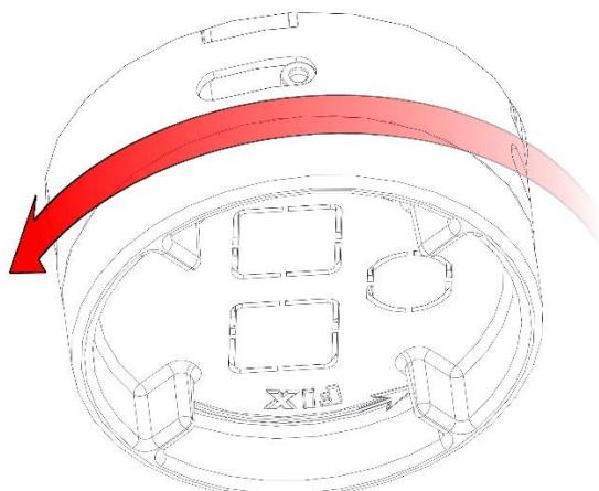
Donji poklopac zatim rotirati u pravcu strelice "FIX" dok se uređaj potpuno ne pričvrsti za ploču u koju se ugrađuje
