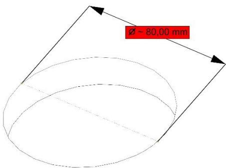
Otvor za postavljanje uređaja je  $\varnothing$  80mm
