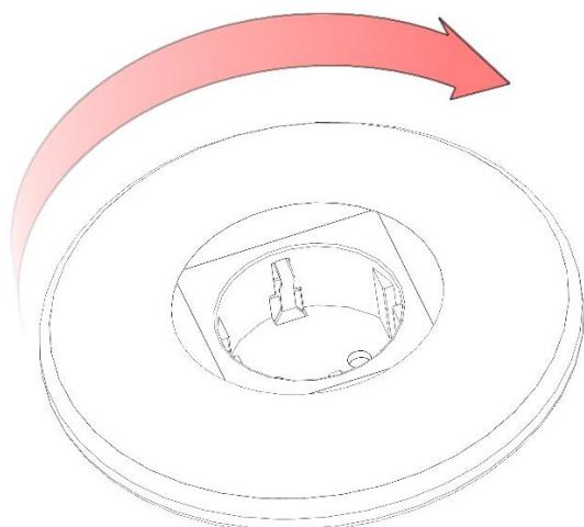
Rotacijom gornjeg poklopca uređaja u desnu stranu obezbeđuje se pristup ugrađenim utičnicama. Kada se uređaj ne koristi rotiranjem na suprotnu stranu zatvaramo pristup utičnicama i tako ih čuvamo od spoljnih uticaja.
