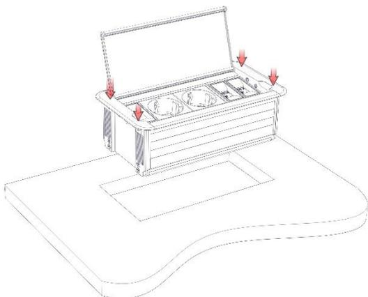
Postaviti uređaj u izrezani otvor i polako ga spustiti dok obod uređaja ne dodirne gornju površinu.
