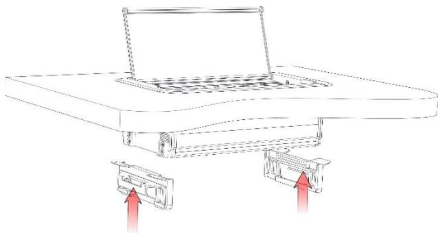
Klizne fiksatore vratiti na uređaj snažno ih gurajući na gore sve dok se uređaj ne fiksira za ploču radne površine. Povezati uređaj na niskonaponsku mrežu preko kabla.
