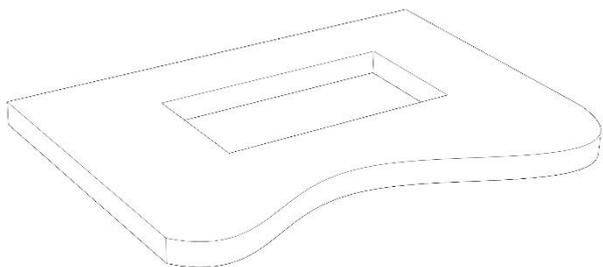
U površini na koju se montira uređaj "KompaktS" potrebno je napraviti otvor po dimenzijama datim na pakovanju.
